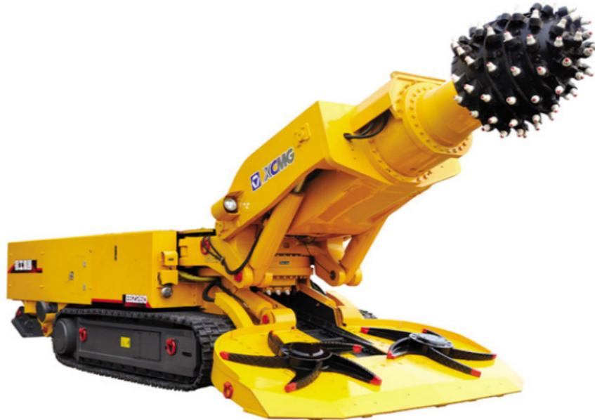
隧道掘进机是用机械破碎岩石、出碴和支护实行连续作业的一种综合设备。按掘进机在工作面上的切削过程，分为全断面掘进机和部分断面掘进机。按破碎岩石原理不同，又可分为滚压式（盘形滚刀）掘进机和铣切式掘进机。中国产品多为滚压式全断面掘进机，适于中硬岩至硬岩。铣切式掘进机适用于煤层及软岩中。在推进油缸的轴向压力作用下，电动机驱动滚刀盘旋转，将岩石切压破碎，其周围有勺斗，随转动而卸到运输带上。硬岩不需支护，软岩支护时可喷射、浇灌混凝土或装配预制块。该机在岩性均匀、巷道超过一定长度时使用，经济合理。
