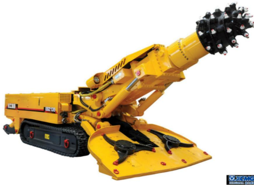
2014年徐工首台隧道掘进机助力吉林高速建设。由徐工自主研发的首台XTR260隧道掘进机闪耀在吉林某隧道施工工程中。此次隧道掘进的成功施工，标志着徐工在隧道掘进方面又迈出了坚实的一步。该工程为分离式隧道，出入口均为端墙式洞口，需要通过碎石土、全风化花岗岩、强风化花岗岩、中风化花岗岩和闪长玢岩。与传统炮掘施工方式容易发生坍塌事件相比，隧道掘进机施工具有效率高、安全性好、开挖断面尺寸可控、施工成本更低等诸多优点。徐工XTR260隧道掘进机配备自动卷电缆系统和可旋转电缆高架，减轻了工人劳动强度，提高了工作效率。高压喷雾除尘系统配备封闭式水箱和高压喷雾泵，采用多角度喷雾，配合可选风机除尘，有效改善隧道除尘效果。值得一提的是XTR260隧道掘进机开挖断面大，7米高的断面可一次成型。我公司从掘进机售出后就对用户进行各种服务和技术指导，保障施工的顺利实施，得到了客户的高度认可，赢得了业界对XTR260隧道掘进机的高度关注。徐工掘进机电控系统设计分析。成都掘进机多少钱
